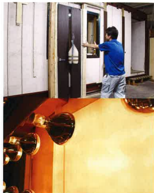
→環境試験室での衝撃剥離試験(振り子)(上)と照射加熱試験(下)。ここでは、他にねじれ剛性試験等も行っている(伊勢原工場。同社提供)
